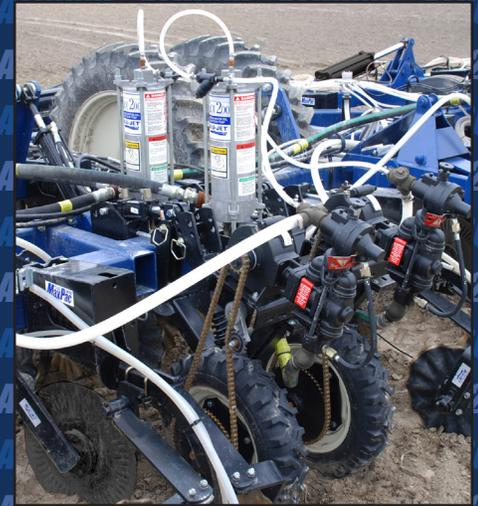
Системы с двойным прямым впрыском для точности распределения и внесения аммиака в почву, обеспечивающие эффективную и быструю работу даже в холодную погоду.
