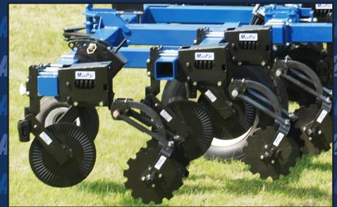
Пружины BLU-JET MaxPac обеспечивают требуемую глубину введения даже в твердом каменистом грунте.
